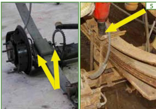
5. Déboulonner les boulons standards ou en « U » (modèles avec ressorts à lames).
