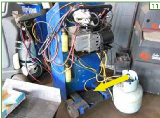
11. Déterminer la quantité de gaz récupérée à l'aide d'une balance.
