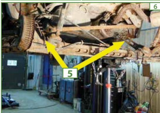
6. **Préalable:** Déboulonner les deux bras oscillants (modèles à ressort hélicoïdal).
